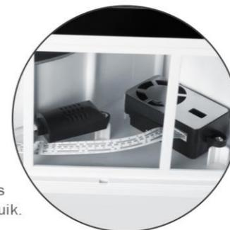
U kunt de CO<sub>2</sub>-sensor eenvoudig reinigen met een stofzuiger. Deze is toegankelijk via het onderste filterluik.
